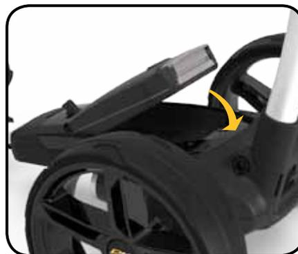
Um die Batterie zu entfernen, schalten Sie sie zunächst über den Netzschalter aus. Ziehen Sie an der grauen Verriegelung, um die Batterie zu entriegeln, bevor Sie sie aus dem Rahmen entnehmen.
